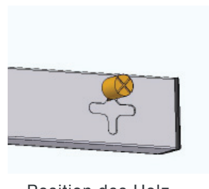
Position des Holzstempels für horizontale Montage
